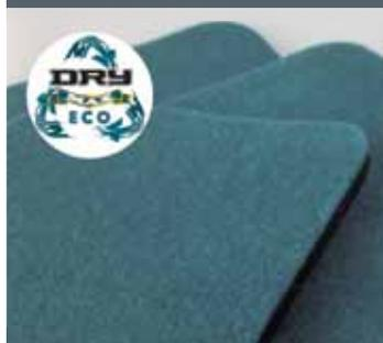
一見普通の糸に見えて、その中心に空洞をもち、多くの空気層を形成する中空糸と回収された PET 端材からマテリアルリサイクルにより生まれ変わったリサイクル糸とをほぼ半数の割合で組み込んだ DRY MAX ECO。これらの全てのポリエステル素材にすることで圧倒的な乾きの速さを実現しました。ダイビング中の快適さはもちろん、ダイビング後も裏返して干せば、瞬時に水分をドロップさせ表面をサラッと快適に保ちます。【最高の速乾性】を備えたエコロジー起毛素材!
